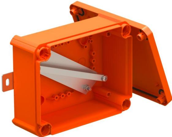
Unbestückter, geschlossener Verbindungs- oder Kabelabzweigkasten zur freien Konfektionierung mit Keramikklemmen und Kabelverschraubungen. Maß A gibt die verfügbare Tragschienenlänge für die Verdrahtungsklemmen an. Ausreichender Verdrahtungsraum durch diagonal angeordnete Tragschiene. Befestigung an gut zugänglichen Außenlaschen aus Edelstahl. Zugelassen für Kabelanlagen mit elektrischem Funktionserhalt nach DIN 4102 Teil12 mit den Klassen E30, E60 und E90.
