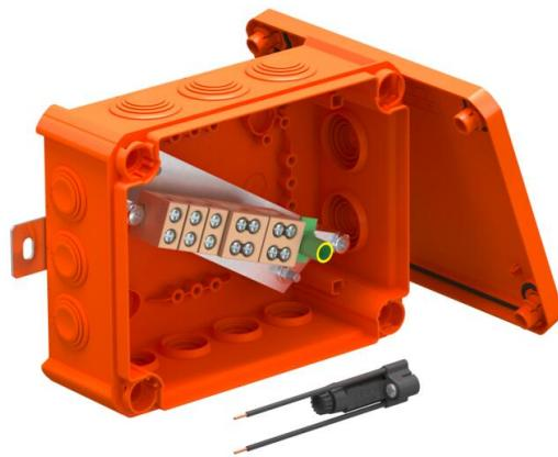
Kabelabzweigkasten mit einem Sicherungshalter und weichen Einstechdichtungen. Ausreichender Verdrahtungsraum durch diagonal angeordnete Anschluss-einheit mit komplett vormontierten hochtemperaturbeständigen Keramikklem-men. Grün-gelb gekennzeichnete Schutzleiterklemme. Befestigung an gut zu-gänglichen Außenlaschen. Zugelassen für Kabelanlagen mit elektrischem Funkti-onserhalt nach DIN 4102 Teil 12 mit den Klassen E30, E60 und E90. Keramik-klemmen wurden nach DIN EN 60998-2-1:2004 geprüft.
