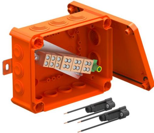
Kabelabzweigkasten mit zwei Sicherungshaltern und weichen Einstechdichtungen. Ausreichender Verdrahtungsraum durch diagonal angeordnete Anschluss-einheit mit komplett vormontierten hochtemperaturbeständigen Keramikklemmen. Grün-gelb gekennzeichnete Schutzleiterklemme. Befestigung an gut zu-gänglichen Außenlaschen. Zugelassen für Kabelanlagen mit elektrischem Funkti-onserhalt nach DIN 4102 Teil 12 mit den Klassen E30, E60 und E90. Keramik-klemmen wurden nach DIN EN 60998-2-1:2004 geprüft.
