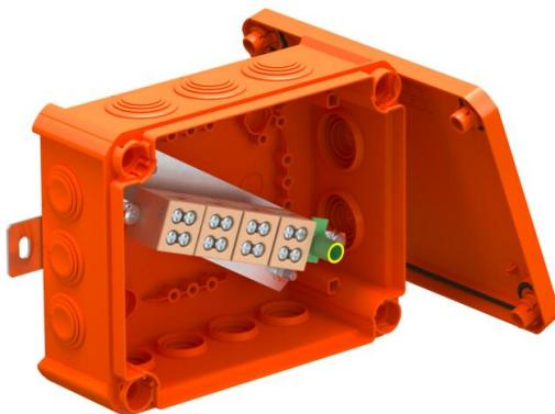
Kabelabzweigkasten mit keramischen Doppelklemmen und weichen Einstektdichtungen. Ausreichender Verdrahtungsraum durch diagonal angeordnete Anschlusseinheit mit komplett vormontierten hochtemperaturbeständigen Keramikklemmen. Grün-gelb gekennzeichnete Schutzleiterklemme. Befestigung an gut zugänglichen Außenlaschen. Zugelassen für Kabelanlagen mit elektrischem Funktionserhalt nach DIN 4102 Teil 12 mit den Klassen E30, E60 und E90. Keramikklemmen wurden nach DIN EN 60998-2-1:2004 geprüft.
