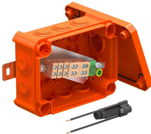
Kabelabzweigkasten mit einem Sicherungshalter und weichen Einstechdichtungen. Ausreichender Verdrahtungsraum durch diagonal angeordnete Anschluss-einheit mit komplett vormontierten hochtemperaturbeständigen Keramikklemmen. Grün-gelb gekennzeichnete Schutzleiterklemme. Befestigung an gut zu-gänglichen Außenlaschen. Zugelassen für Kabelanlagen mit elektrischem Funkti-onserhalt nach DIN 4102 Teil 12 mit den Klassen E30, E60 und E90. Keramik-klemmen wurden nach DIN EN 60998-2-1:2004 geprüft.
