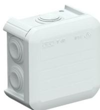
Boîtier de dérivation pour le raccordement de câbles et de lignes en intérieur et en extérieurs protégés. Forme carrée avec des joints d'étanchéité sur les côtés et des ouvertures prédécoupées défonçables dans le fond. Convient pour le montage au mur/au plafond et sur des tôles de montage. Avec possibilité de fixation intérieure. Avec couvercle fixe à encliqueter. Fabriqué à partir de matériaux sans halogène et résistants aux UV.
