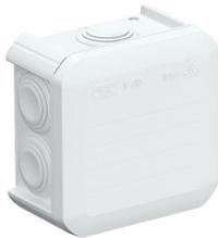
Kabelabzweigkasten zum Verbinden von Kabeln und Leitungen im Innenbereich und geschützten Außenbereichen. Quadratische Form mit Einsteckdichtungen an den Seiten und Ausschlageinführungen im Boden. Geeignet für die Wand-/Deckenmontage und die Montage auf Montageblechen. Mit der Möglichkeit zur Innenbefestigung. Mit festsitzendem Klemmdeckel. Hergestellt aus halogenfreien und UV-stabilisierten Materialien.
