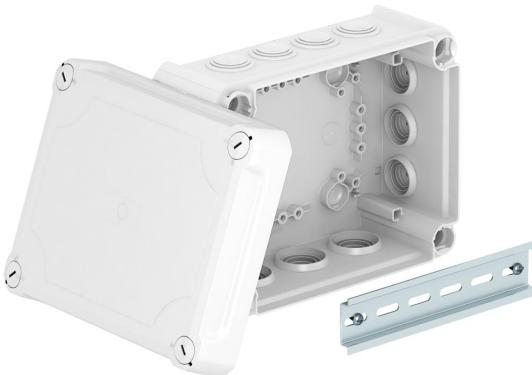
Boîtier de dérivation pour le raccordement de câbles et de lignes en intérieur et en extérieurs protégés. Forme rectangulaire avec des joints d'étanchéité sur les côtés et des ouvertures pré découpées défonçables dans le fond. Convient pour le montage au mur/au plafond et sur des tôles de montage. Avec possibilité de fixation intérieure et de montage au dessus des dômes angulaires. Couvercle haut avec fermeture rapide, plombable. Fabriqué à partir de matériaux sans halogène et résistants aux UV.
