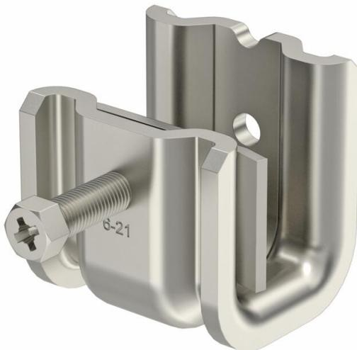
Diese Art Trägerklammer wird auf den Träger aufgeschoben und mittels einer Druckwanne und Schraube (M8) am Träger oder Flacheisen fixiert. Die Sechskantschraube hat eine Schlüsselweite von 10 mm. Im Schellenkörper sind außerdem zwei weitere M6 Gewinde eingebracht, um zum Beispiel Gewindestangen zu befestigen.
