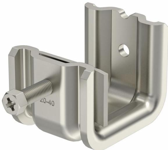
Questo tipo di griffe di supporto viene spinto sulle travi e fissato con coppa e vite (M8) alla trave o ai profilati piatti. La vite a testa esagonale ha un'apertura di chiave di 10 mm. Nella griffa sono inoltre presenti due altre filettature M8, per fissare per esempio delle aste filettate.
