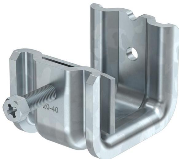
Ce type de pince de fixation est poussé sur le support et fixé sur le support ou un fer plat au moyen d'un patin de pression et d'une vis (M8). La vis hexagonale est dotée d'une ouverture de clé 10 mm. En outre, dans le corps de bride, deux autres filets M6 sont prévus pour fixer entre autres des tiges filetées.
