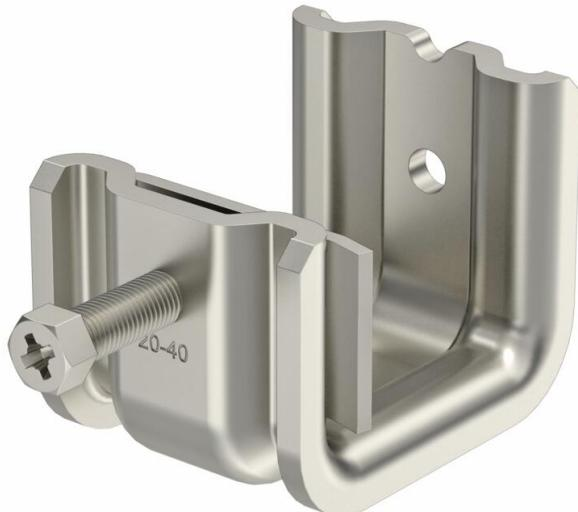
Diese Art Trägerklammer wird auf den Träger aufgeschoben und mittels einer Druckwanne und Schraube (M8) am Träger oder Flacheisen fixiert. Die Sechskantschraube hat eine Schlüsselweite von 10 mm. Im Schellenkörper sind außerdem zwei weitere M6 Gewinde eingebracht, um zum Beispiel Gewindestangen zu befestigen.
