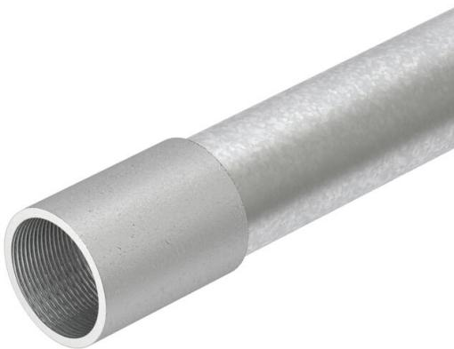
Elektroinstallationsrohr nach EN 61386-1, mit Gewindeenden nach DIN EN 60423, für den mechanischen Schutz von Kabeln und Leitungen.
