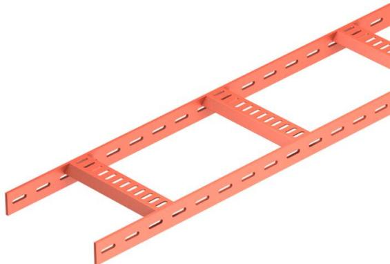
Passerella a scaletta per impianti navali con longherone laterale forato con bordo di altezza pari a 40 mm con pioli trapezoidali saldati, forati, aperti verso il basso. Carico testato secondo IEC in combinazione con connettore tipo SLV. Fondo di saldatura tipo SIGMA-WELD 199.
