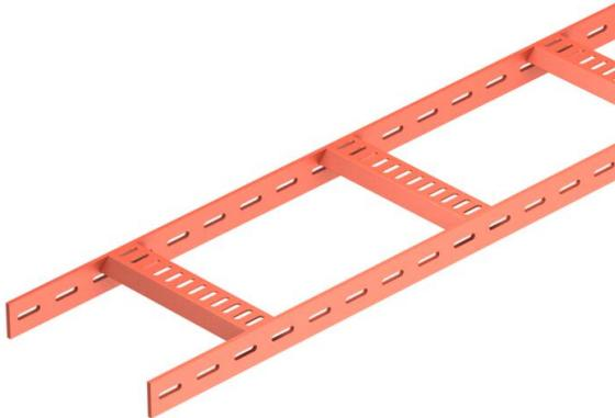
Schiffbau-Kabelleiter mit gelochtem Seitenholm in der Seitenhöhe 40 mm mit eingeschweißten, nach unten offenen, gelochten Trapezsprossen. Belastung geprüft nach IEC in Kombination mit Verbinder Typ SLV. Schweißgrundierung Typ SIGMA-WELD 199.
