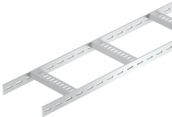
Échelle à câbles dédiée à la construction navale avec longeron latéral perforé d'une hauteur latérale de 40 mm, avec échelons trapézoïdales soudés et perforées, ouverts vers le bas.
