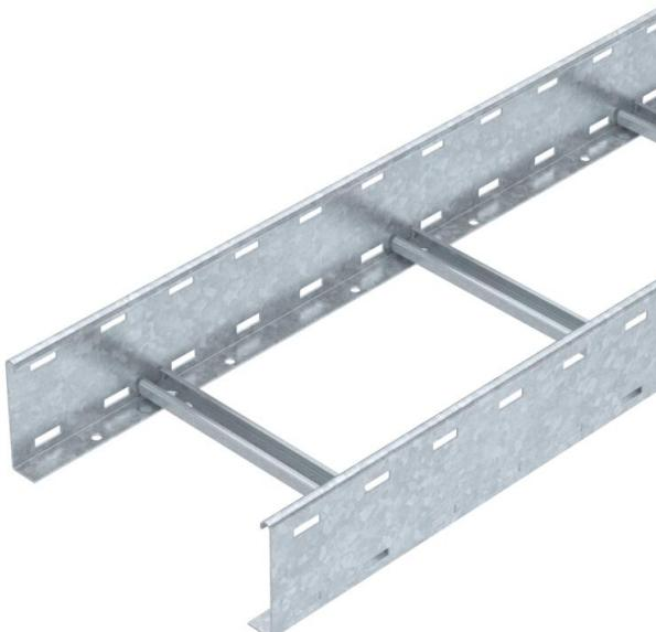
Échelle à câbles d'une hauteur latérale de 110 mm avec échelons soudés à profilé C30 ouvert vers le haut. Longerons latéraux enroulés pour le renforcement et la protection des bords. La fixation sur console s'effectue avec des pièces de serrage de type LKS 40. La fente de l'échelon mesure 16,5 mm. La bride de fixation correspondante est de type 2056.
