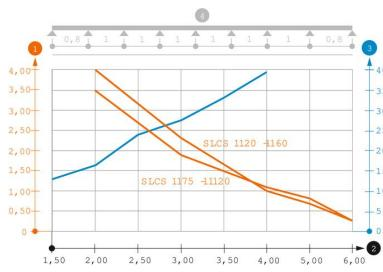
Diagramme de charge de l'échelle à câbles type SLCS 110
