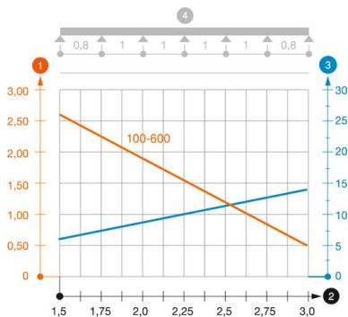
Diagramme de charge du chemin de câbles de type SKS 60 VA
