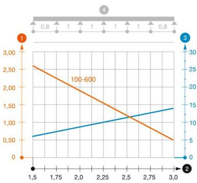
Belastungsdiagramm Kabelrinne Typ SKS 60
