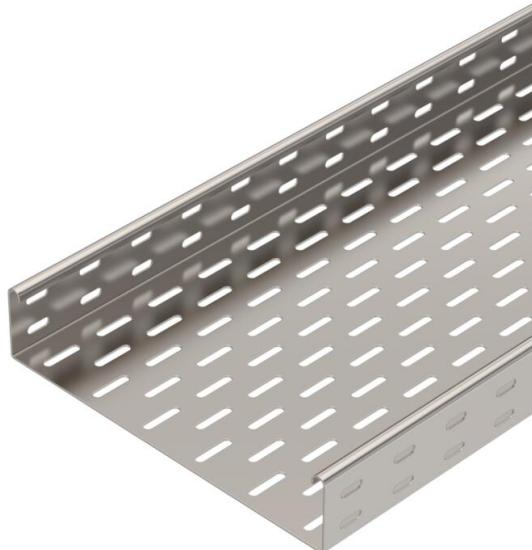
SKS 60 = Système de chemins de câbles lourd d'une hauteur latérale de 60 mm. Le chemin de câbles type SKS peut également être utilisé pour le maintien en fonction. Pour d'autres informations, se reporter aux systèmes de protection contre les incendies BSS ; Kit d'éclissage droit type RV 60 inclus dans la livraison. Ce chemin de câbles est fixé sur la console à l'aide de vis à tête bombée FRS M6 x 12.
