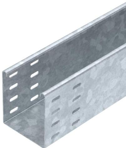
SKS 110 = Schweres-Kabelrinnen-System in 110 mm Seitenhöhe. Mit Verbinderlochung an beiden Kabelrinnenenden. Längsverbindung mit Längsverbinder RL-VA 110 FT. Verbinder müssen separat bestellt werden.
