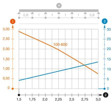
Belastungsdiagramm Kabelrinne Typ SKSMU 85
