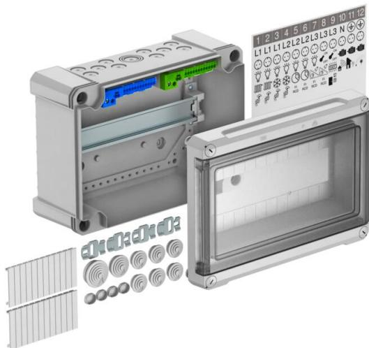
Distributore piccolo con morsettiera per montaggio a parete, per sottoquadro distribuzione corrente in ambienti interni ed esterni, secondo IEC 439-3. Con profilo di sospensione premontato 35 mm. Tipo di protezione IP66 e grado di protezione IK08. Coperchio trasparente avvitabile, con intaglio
