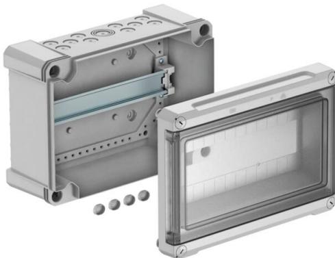
Kleinverteiler zur Aufputz-Montage, für die Strom-Untererteilung im Innen- und geschützten Außenbereich, gemäß IEC 439-3. Mit vormontierter 35-mm-Hutprofileinschiene. Schutzzart IP66 und Schutzgrad IK07. Transparenter Deckel zum Schrauben, mit Ausschnitt.
