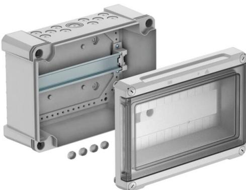
Distributore piccolo per montaggio a parete, per sottoquadro distribuzione corrente in ambienti interni ed esterni, secondo IEC 439-3. Con profilato di sospensione premontato 35 mm. Tipo di protezione IP66 e grado di protezione IK08.
