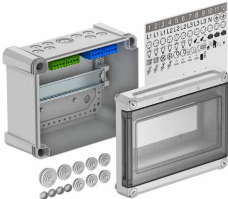
Distributore piccolo con morsettiera per montaggio a parete, per sottoquadro distribuzione corrente in ambienti interni e ambienti esterni protetti, secondo IEC 439-3. Con profilo di sospensione premontato 35 mm. Tipo di protezione IP66 e grado di protezione IK07. Coperchio trasparente avvitabile, con intaglio
