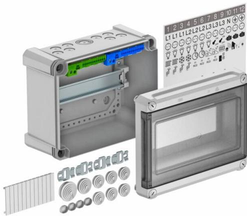
Kleinverteiler mit Klemmleiste zur Aufputz-Montage, für die Strom-Unterverteilung im Innen- und Außenbereich, gemäß IEC 439-3. Mit vormontierter 35-mm-Hutprofilschiene. Schutzart IP66 und Schutzgrad IK08. Transparenter Deckel zum Schrauben, mit Ausschnitt.
