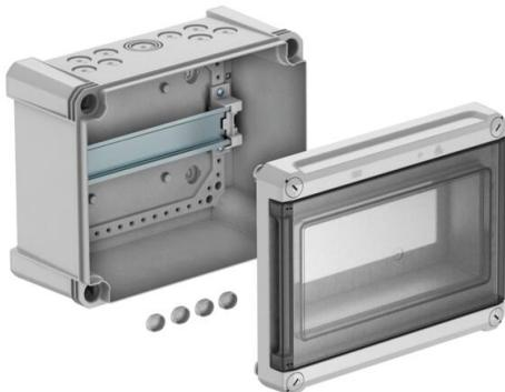
Distributore piccolo per montaggio a parete, per sottoquadro distribuzione corrente in ambienti interni e ambienti esterni protetti, secondo IEC 439-3. Con profilo di sospensione premontato 35 mm. Tipo di protezione IP66 e grado di protezione IK07. Coperchio trasparente avvitabile, con intaglio
