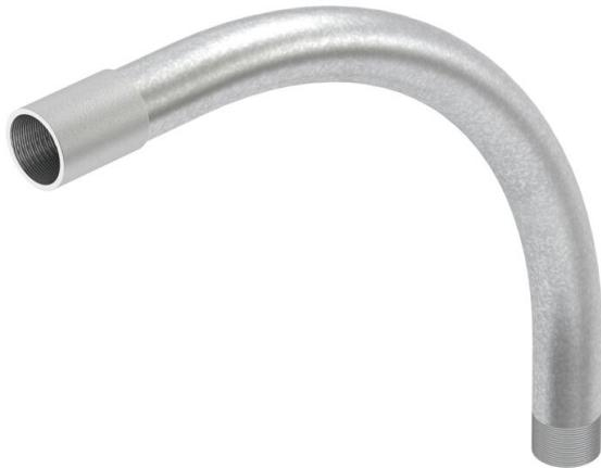
Raccordo a gomito 90° per tubi d'installazione elettrica secondo EN 61386-1 con estremità filettata secondo EN 60423. Parete interna senza sbavature.
