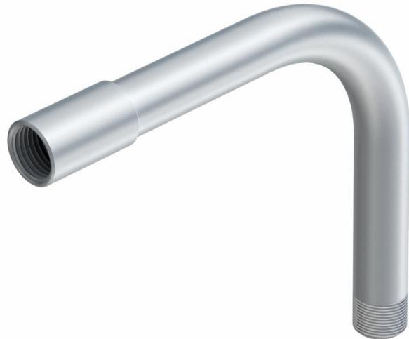
90°-Bogen für Elektroinstallationsrohre nach EN 61386-1 mit Gewindeenden nach DIN EN 60423. Mit grätfreier Innenwand.
