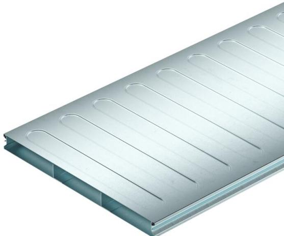
Canale sotto pavimento (2 parti) per la posa di cavi e linee nei sistemi sotto pavimento sotto battuto a norma EN 50085-2-2. Coperchio del canale estraibile e ad innesto universale. Con separatore nella parte inferiore del canale. Portata massima fino a 1,5 kN.
