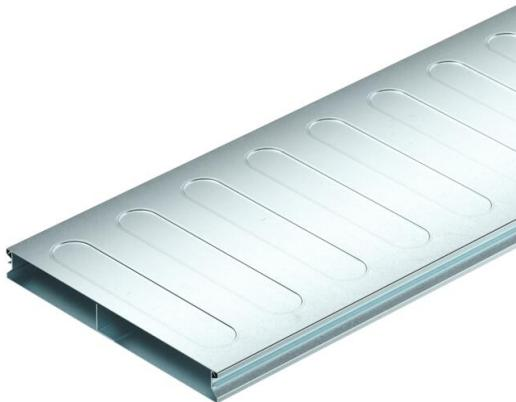
Unterflurkanal (2-teilig) zur Verlegung von Kabeln und Leitungen in Estrichüberdeckten Unterflur-Systemen nach EN 50085-2-2. Abnehmbarer und durchgängig aufrastbarer Kanaldeckel. Mit Trennsteg im Kanalunterteil. Maximale Belastbarkeit bis 1,5 kN.
