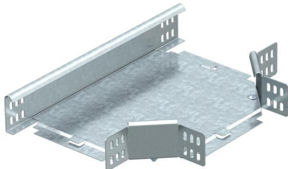
T-Abzweigstück, horizontal, für alle Kabelrinnentypen mit der Seitenhöhe 60 mm. Das Formteil wird in unmontiertem Zustand geliefert. Alle Seiten sind für die gleiche Kabelrinnenbreite. Inklusive anteiligem Befestigungsmaterial.
