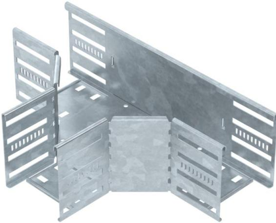
T-Stück zum Erstellen einer horizontalen Abzweigung, Formteil für rast- und schraubbare Kabelrinnen Seitenhöhe 110 mm. Schraubenlose Montage mit Doppelklemmen oder Schraubverbindung mit Flachrundschrauben FRS und Kombimuttern M6. Einsetzbar im Innen- und Außenbereich. Befestigungsmaterial muss separat bestellt werden.
