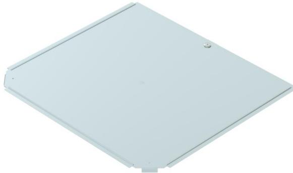
Couvercle pour pièce de forme pièce en T pour chemins de câbles encliquetables et vissables en intérieur et en extérieur, pour protéger le câble contre les dommages et la saleté. Fixation avec verrou tournant prémonté et fixation par appui sur le couvercle pour chemin de câbles. Convient à toutes les hauteurs d'ailes.
