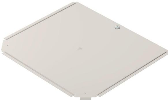
Deckel für Formteil T-Stück für rastbare und schraubbare Kabelrinnen im Innen- und Außenbereich, zum Schutz der Kabel vor Beschädigungen und Schmutz. Befestigung mit vormontiertem Drehriegel und Befestigung durch Auflage des Streckendeckels. Passend für alle Seitenhöhen. Der Deckel kann bei Formteilen in allen Seitenhöhen eingesetzt werden.
