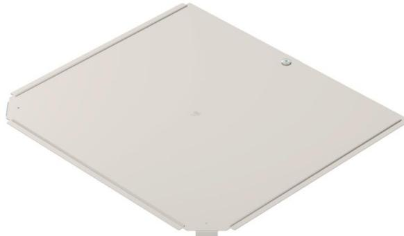
Deckel für Formteil T-Stück für rastbare und schraubbare Kabelrinnen im Innen- und Außenbereich, zum Schutz der Kabel vor Beschädigungen und Schmutz. Befestigung mit vormontiertem Drehriegel und Befestigung durch Auflage des Streckendeckels. Passend für alle Seitenhöhen. Der Deckel kann bei Formteilen in allen Seitenhöhen eingesetzt werden.
