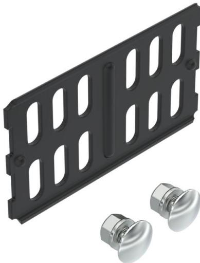
Raccord droit pour l'assemblage linéaire des chemins de câbles et des éléments préformés d'une hauteur latérale de 60 mm. Revêtement par poudrage en noir foncé (RAL 9005). Avec matériel de fixation en quantités nécessaires. La continuité de la compensation de potentiel est assurée par l'assemblage vissé.
