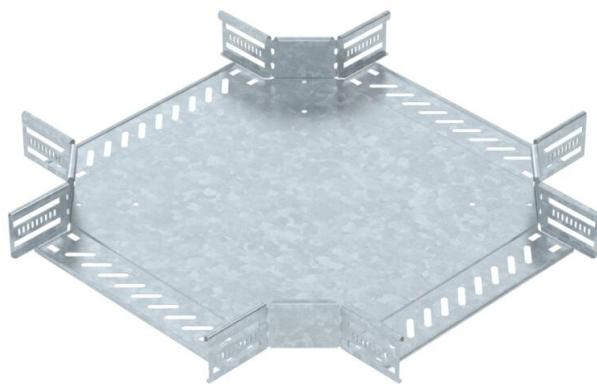
Kreuzung zum Erstellen einer horizontalen Abzweigung, Formteil für rast- und schraubbare Kabelrinnen Seitenhöhe 60 mm. Schraubenlose Montage mit Doppelklemmen oder Schraubverbindung mit Flachrundschrauben FRS und Kombimuttern M6. Einsetzbar im Innen- und Außenbereich. Befestigungsmaterial muss separat bestellt werden.
