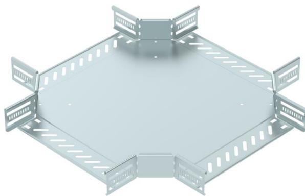
Kreuzung zum Erstellen einer horizontalen Abzweigung, Formteil für rast- und schraubbare Kabelrinnen Seitenhöhe 60 mm. Schraubenlose Montage mit Doppelklemmen oder Schraubverbindung mit Flachrundschrauben FRS und Kombimuttern M6. Einsetzbar im Innenbereich. Befestigungsmaterial muss separat bestellt werden.
