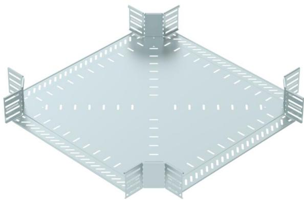
Kreuzung zum Erstellen einer horizontalen Abzweigung, Formteil für rast- und schraubbare Kabelrinnen Seitenhöhe 110 mm. Schraubenlose Montage mit Doppelklemmen oder Schraubverbindung mit Flachrundschrauben FRS und Kombimuttern M6. Einsetzbar im Innenbereich. Befestigungsmaterial muss separat bestellt werden.
