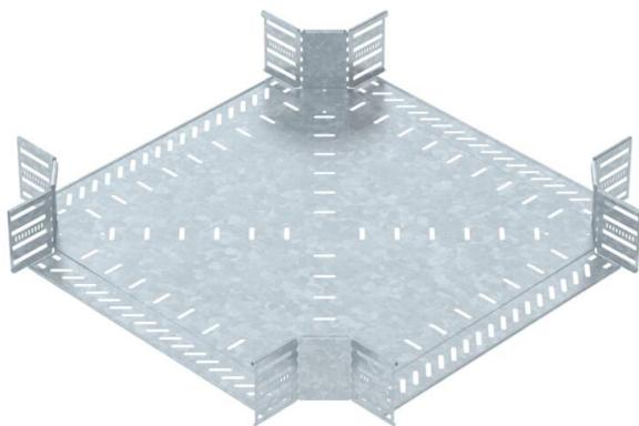
Kreuzung zum Erstellen einer horizontalen Abzweigung, Formteil für rast- und schraubbare Kabelrinnen Seitenhöhe 110 mm. Schraubenlose Montage mit Doppelklemmen oder Schraubverbindung mit Flachrundschrauben FRS und Kombimuttern M6. Einsetzbar im Innen- und Außenbereich. Befestigungsmaterial muss separat bestellt werden.
