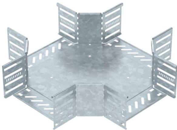
Kreuzung zum Erstellen einer horizontalen Abzweigung, Formteil für rast- und schraubbare Kabelrinnen Seitenhöhe 110 mm. Schraubenlose Montage mit Doppelklemmen oder Schraubverbindung mit Flachrundschrauben FRS und Kombimuttern M6. Einsetzbar im Innen- und Außenbereich. Befestigungsmaterial muss separat bestellt werden.
