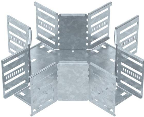
Kreuzung zum Erstellen einer horizontalen Abzweigung, Formteil für rast- und schraubbare Kabelrinnen Seitenhöhe 110 mm. Schraubenlose Montage mit Doppelklemmen oder Schraubverbindung mit Flachrundschrauben FRS und Kombimuttern M6. Einsetzbar im Innen- und Außenbereich. Befestigungsmaterial muss separat bestellt werden.
