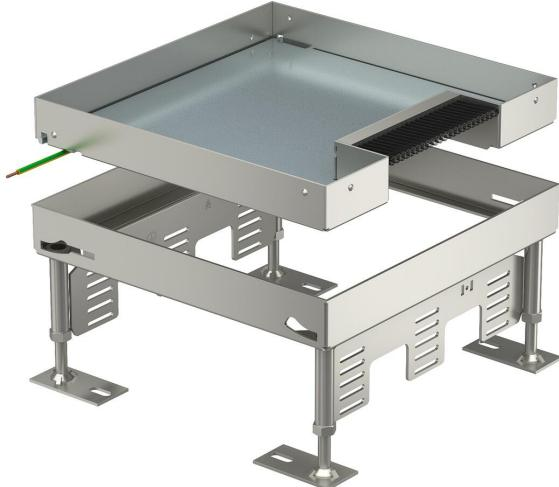
Cassetta livellabile di dimensione nominale 9 con uscita cavo tramite spazzola per il montaggio di apparecchi di installazione in pavimenti trattati a secco. Possono essere montati fino a 11 apparecchi di installazione del tipo costruttivo FLF.
