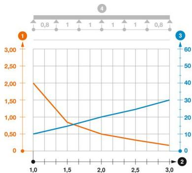
Belastungsdiagramm Kabelrinne Typ RKS 60
