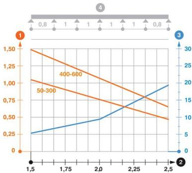
Belastungsdiagramm Kabelrinne Typ RKS 60 ungesickt
