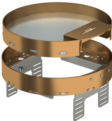
Nivellierbare und vom Fußboden entkoppelte Kassette der Nenngröße R4 mit Schnurauslass, für den Einbau von Installationsgeräten in trocken gepflegten im Innenbereich, zur Montage in Unterflurdosens UZD250-3 oder UZD350-3, jeweils in Verbindung mit einem Montagedeckel DUG..R4 oder in UGD250-3R4 oder UGD350-3R4. Die Montage erfolgt mittels Nivellierwinkeln (separat bestellen) im Aluminium-Rahmenprofil der Unterflurdosens.
