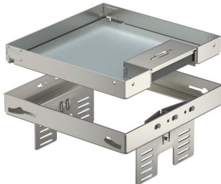
Nivellierbare und vom Fußboden entkoppelte Kassette der Nenngröße 4, mit Schnurauslass, für den Einbau von Installationsgeräten in trocken gepflegten Fußböden im Innenbereich, zur Montage in Unterflurdosen UZD250 oder UZD350, jeweils in Verbindung mit einem Montagedeckel DUG../4 oder in UGD250-3/4 oder UGD350-3/4. Die Montage erfolgt mittels Nivellierwinkel (separat bestellen) im Aluminium-Rahmenprofil der Unterflurdosen.
