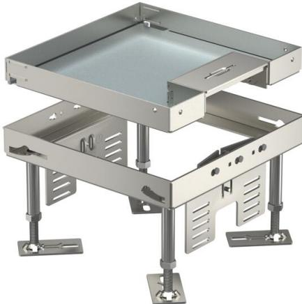
Cassetta livellabile con uscita cavo a 2 vie. È possibile installare 2 piastre di copertura APMT2. Per il montaggio di 2 supporti universali UT3 per 4 apparecchi di installazione singoli con anello/staffa di supporto o 6 apparecchi Modul 45.
